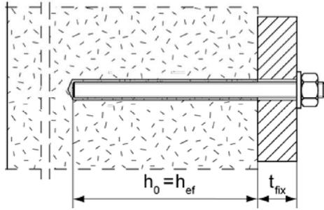
Durchsteckmontage: Ringspalt mit Mörtel verfüllt
