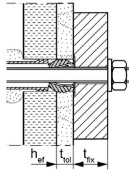
Größe der Injektions-Ankerhülse: FIS H 12x85 K    FIS H 16x130 K    FIS H 20x130 K
